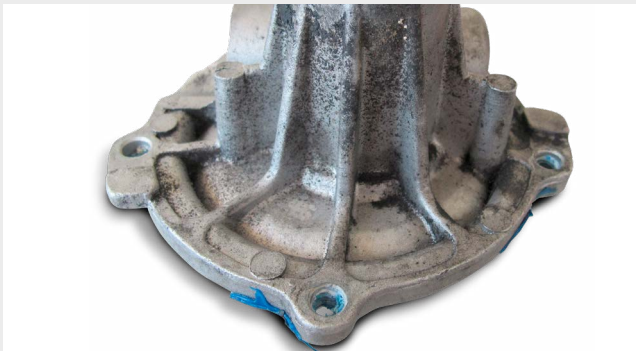
Daños en los cojinetes por problemas de correa (abrasión de goma, partículas en la carcasa)
