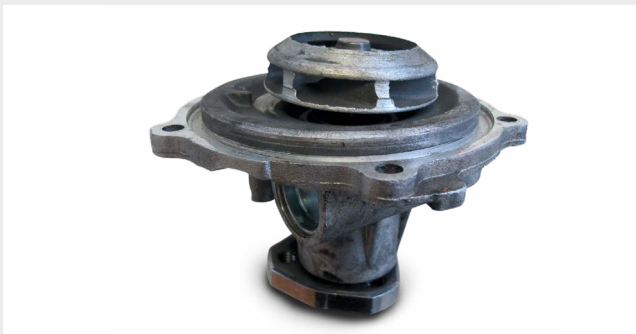
Daños en los cojinetes debido a una tensión excesiva de la correa
