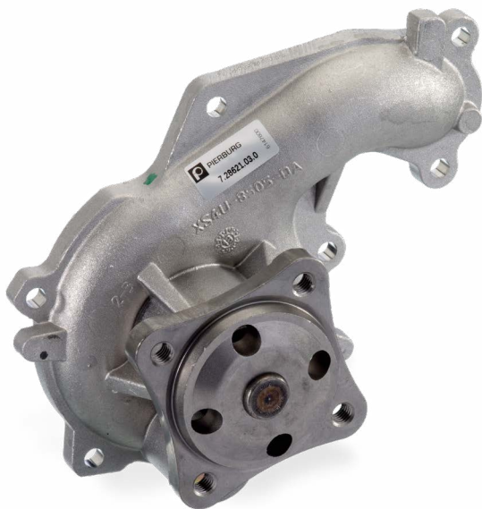
Bomba de montaje autónomo (sin rueda de correa trapezoidal)
