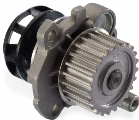
Bomba abridada con accionamiento por correa de distribución
