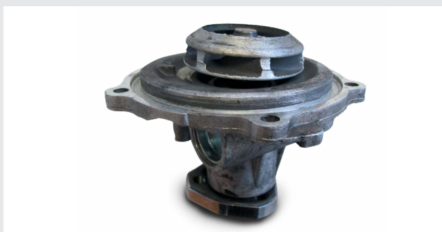
Uszkodzenie łożyska przez zbyt wysokie naprężenie paska
