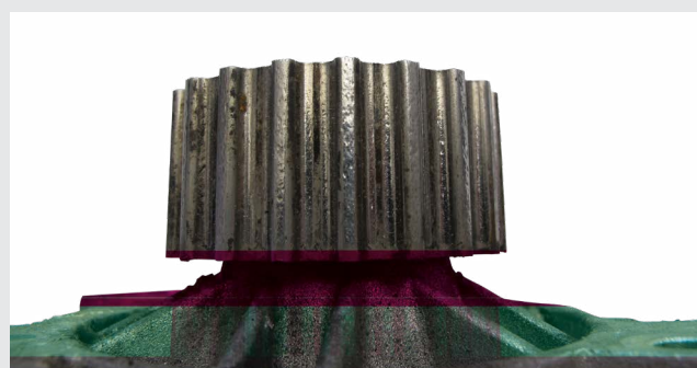
Uszkodzone przez zabrudzenia i zużycie koło napędowe (uszkodzenia łożyska)
