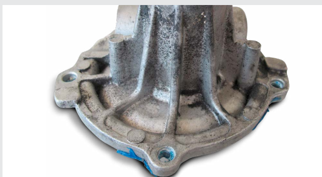
Uszkodzenie łożyska przez problemy z paskiem (ścieranie się gumy, cząstki na obudowie)
