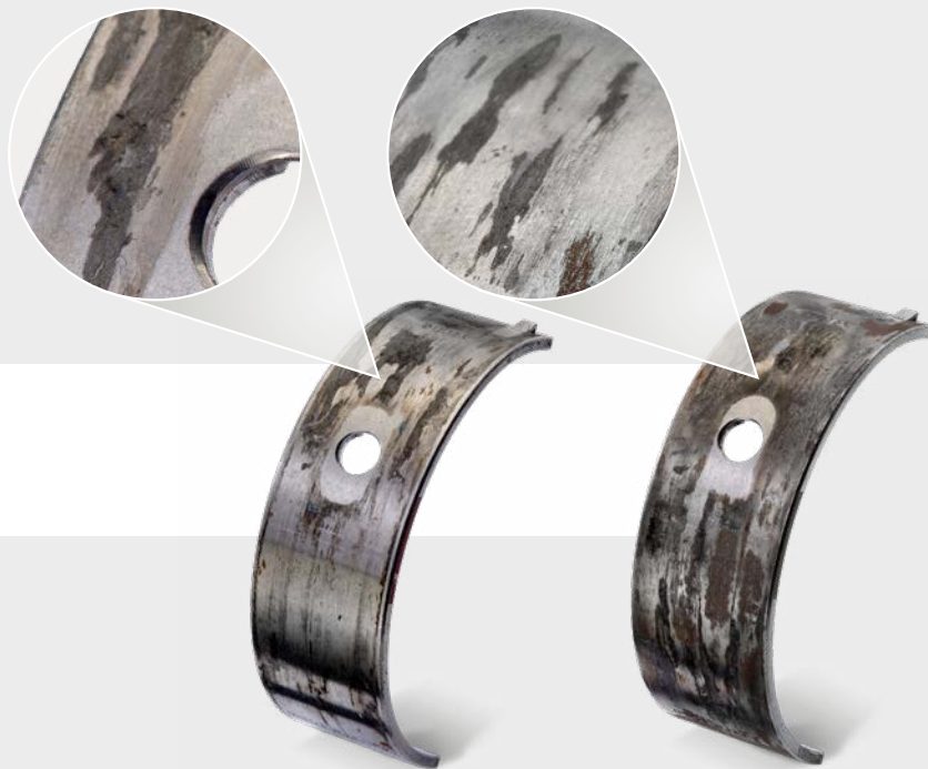
Rys. 2 Częściowo wyrwane fragmenty materiału
