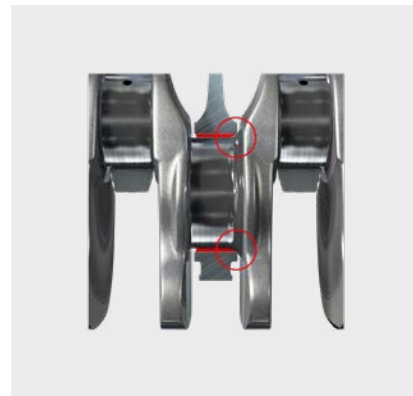
Rys. 3: Jednostronnie za duży promień wyokrąglenia
