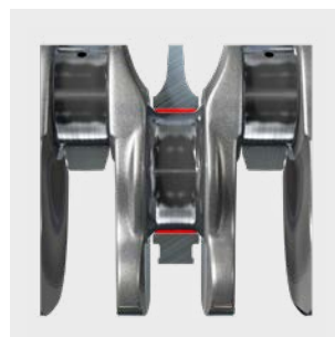
Rys. 3: Zbyt duży promień wyokrąglenia
