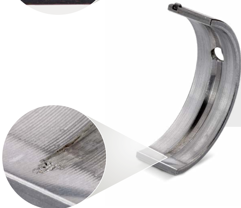
Górne panewki łożyska głównego, wykonane z kompozytu stalowo-aluminiowego
