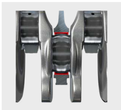
Rys. 1: Zbyt mocno wypukły kształt czopa
