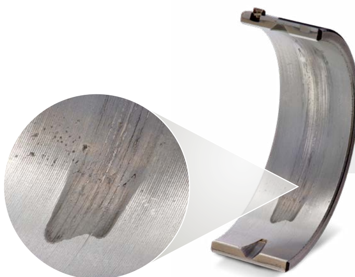
Dolna panewka łożyska głównego, wykonana z kompozytu stalowo-aluminiowego
