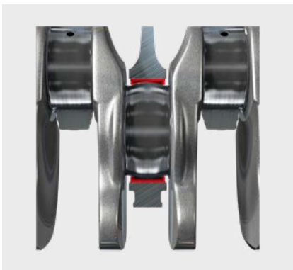
Fig. 1: Forma del perno troppo convessa
