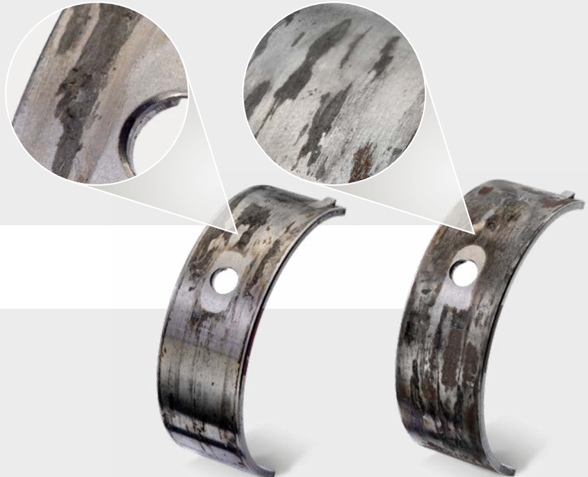
Fig. 2: Aree in cui il materiale risulta in parte strappato via
