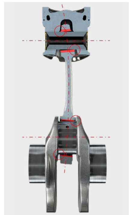
Fig. 2: "Oscillazione assiale" del fusto della biella
