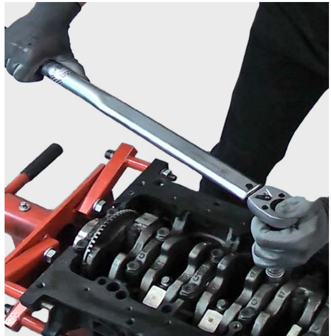
Serraggio delle viti conformemente alle indicazioni del produttore
