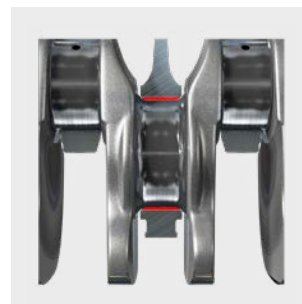
Fig. 3: Raggio dell'arrotondamento eccessivo
