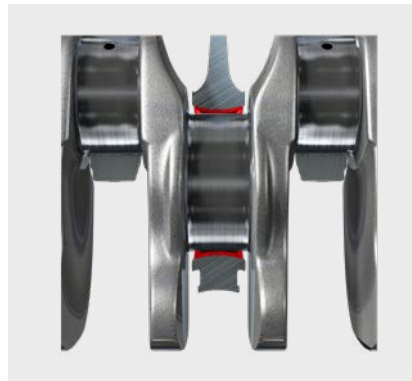
Fig. 2: Foro del cuscinetto concava
