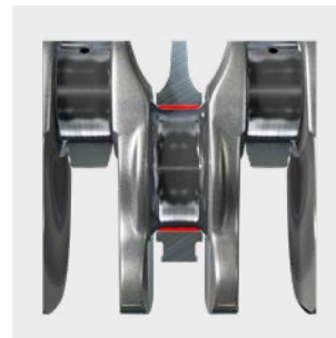
Fig. 3: Radio de redondeado excesivo
