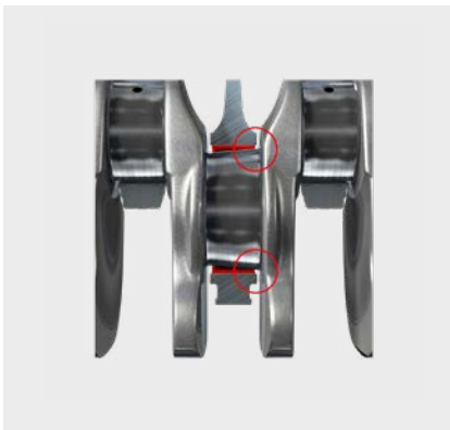
Fig. 1: Muñón rectificadо cónicamente
