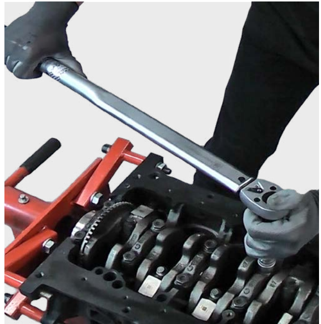
Apriete de los tornillos según las prescripciones del fabricante
