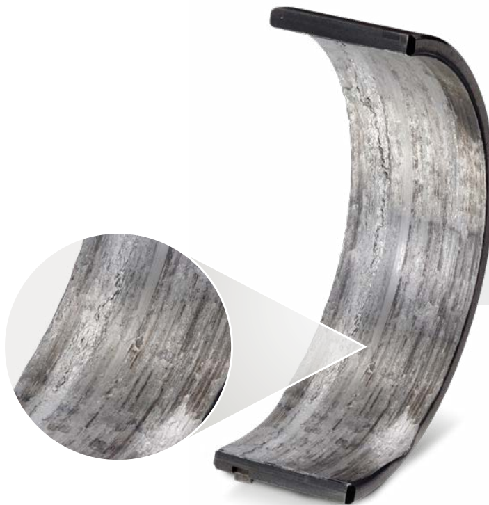
Semicojinete de bancada inferior, material compuesto de acero-aluminio
