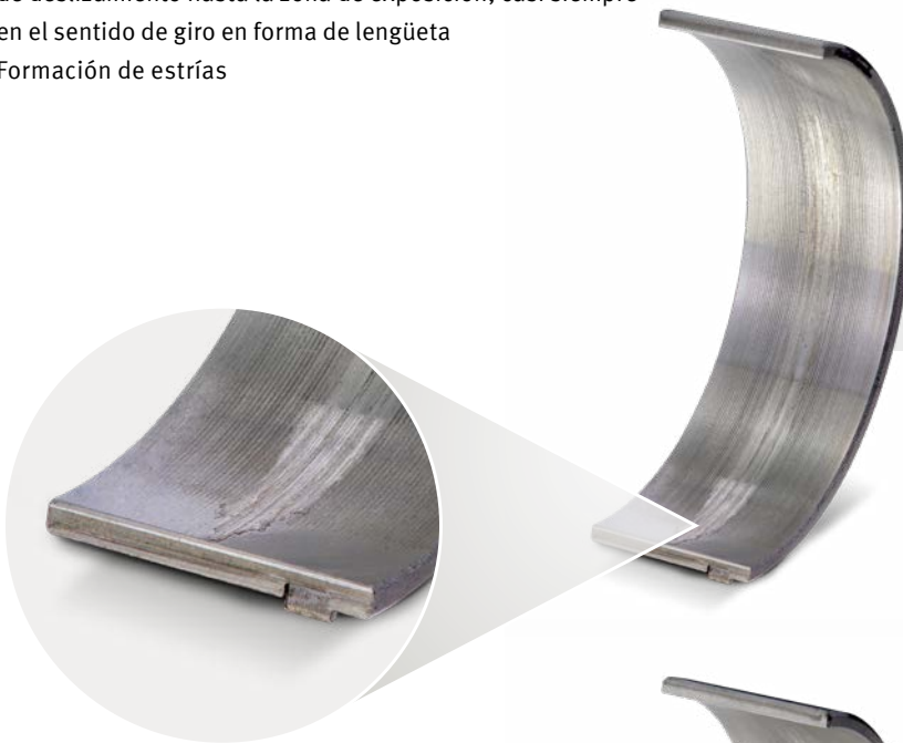
Semicojinete de biela en el lado de la tapa, material compuesto de acero-aluminio
