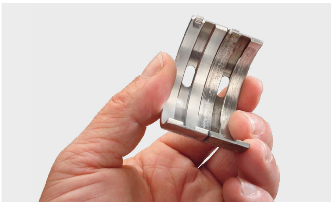
Comparación entre el cojinete de fricción usado y el nuevo
