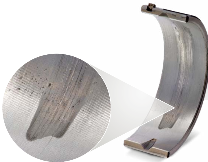
Semicojinete de bancada inferior, material compuesto de acero-aluminio
