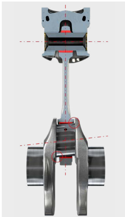
Fig. 1: Error de alineación
