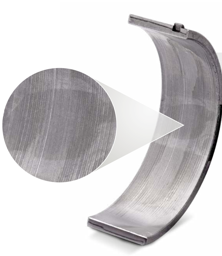
Semicojinete de bancada inferior, material compuesto de acero-aluminio
