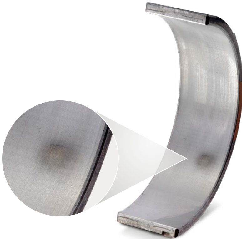
Semicojinete de bancada inferior, material compuesto de acero-aluminio
