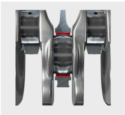
Fig. 1: Forma excesivamente convexa del muñón
